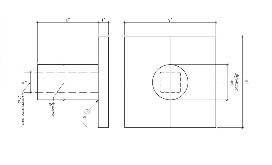
9" X 9" X 1" NEW CONSTRUCTION BRACKET FOR COMPRESSION ONLY
